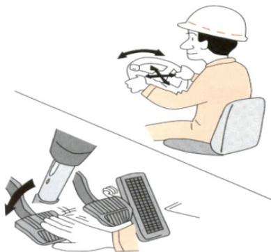
6、各踏板和转向的动作检查。用手按压各踏板，直到感觉到阻力，检查自由行程是否合适。左右转动方向盘，检查自由行程是否合适。上下、前后活动方向盘，检查是否有明显晃动。
