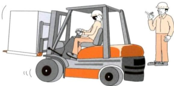
8、叉车司机视线受阻时应倒退行驶。装载大型货物后，司机前方视线不良或受阻，应倒退行驶或者安排专人指挥低速行驶。
