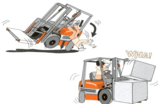
5、转弯时降低速度。高速转弯，可能会发生车辆倾翻或货物倒塌，非常危险。叉车是后轮转向，叉车转弯时右后部大幅度向外拐出，注意确认是否有足够位置转弯。
