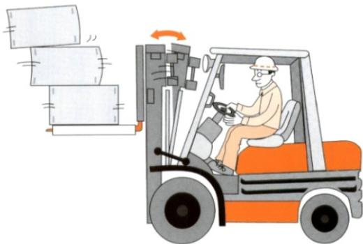
5、高起升状态下，不可前后倾斜门架。在货叉高高升起的状态下，如果进行门架倾斜作业，车辆会变得不稳定，货物以及托盘有滑落、倒塌的危险。
