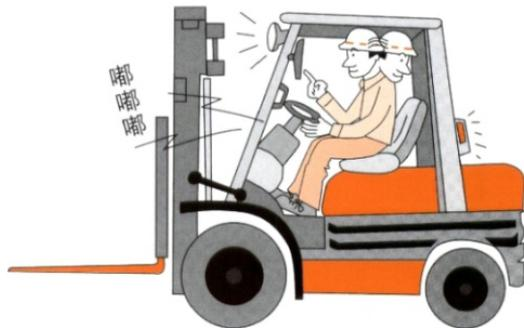
5、灯光喇叭的检查。打开灯光控制开关，检查前大灯、车宽灯、尾灯是否点亮。操作转向灯开关，检查转向灯是否正常闪烁。踩下制动踏板，检查制动灯是否点亮。按下喇叭按钮，检查喇叭是否正常响起。
