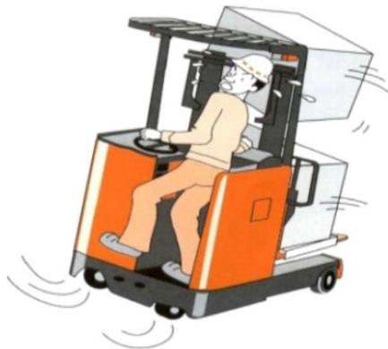
12、前移式叉车转弯时要减速慢行。前移式叉车轮胎的转弯角度大，便于小转弯，相反在稳定性方面存在不利。转弯时应降低速度，缓慢进行。
