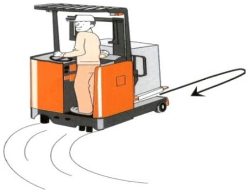
9、不能在弯道掉头。转弯时车辆不稳定，弯道掉头操作存在翻倒以及货物塌落的危险。应在直行道进行掉头操作。
