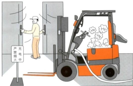
2、电瓶充电时严禁烟火。电瓶充电时要求充电场所通风良好、严禁烟火，充电桩漏电保护及接地安全有效。
