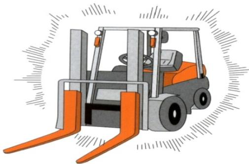
12、作业结束后的检查。检查各部位是否漏油。检查各部位是否有裂纹、损伤。在各部位注入黄油。上下升降货叉，在门架内涂敷润滑油。如果有异常，及时向管理人员报告。
