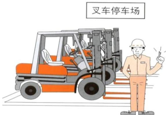
12、叉车停车安全。叉车司机离开叉车时务必拔下钥匙，防止无证人员操作。货叉应降到地面，并养成随时拉上手刹的习惯。
