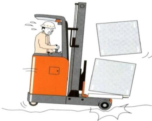
11、前移式叉车不要在路况差的路面上行驶。前移式叉车的轮胎没有胎纹，直径小，行驶路面受限制。特别是路况差的路面上行驶时，叉车可能变得不稳定，可能造成货物倒塌或翻转。
