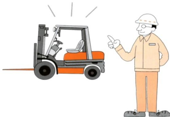
2、坚持定期检查。定期检查主要有月度检查和年度检查。制动装置及操纵装置的功能。装卸装置及液压装置的功能。车轮有无异常。灯光是否正常。
