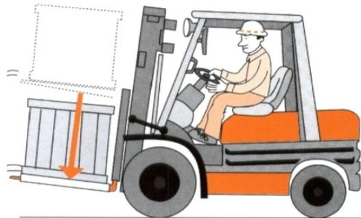
2、降低货叉、门架向后倾斜。装载货物时，应降低重心，稳定车辆，同时向后倾斜门架。货叉高度应距离路面约20cm为准，行驶中不可以进行提升操作。
