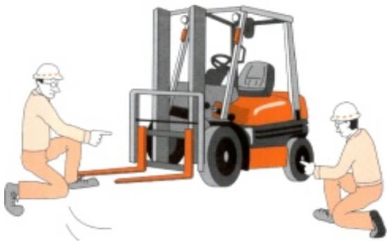
3、叉车的外观检查。绕叉车转一圈，检查车体外观、各护板是否完好。检查安全带是否完好。观察叉车车底是否漏油、漏水。检查轮胎的磨损和损伤等。
