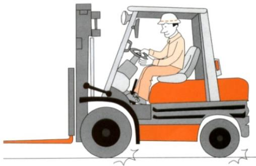
7、叉车行车、驻车制动系统检查。让叉车缓慢行驶，踩下制动踏板，检查行车制动是否有效、是否偏向。让叉车行驶到斜坡处，拉上驻车制动（手刹），检查能否有效驻车制动。
