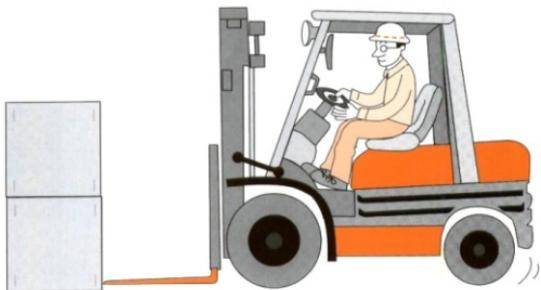
3、不准用单叉作业，不准用货叉推顶货物。移动货物时，务必用货叉叉起货物来移动。
