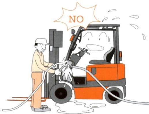
1、电气部件严禁进水。在洗车时，如果电气部件内进水，则会引起误动作，或使绝缘性下降，造成短路和触电。电气部件应使用压缩空气清扫。
