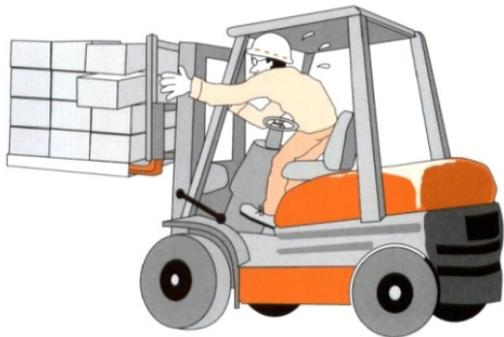
6、严禁将手伸到门架中间扶正货物。作业时严禁叉车司机将手伸到门架中间扶正货物，否则身体可能会触碰到操纵杆，有被门架夹住的危险。务必停车、拉手刹，下车扶正货物。
